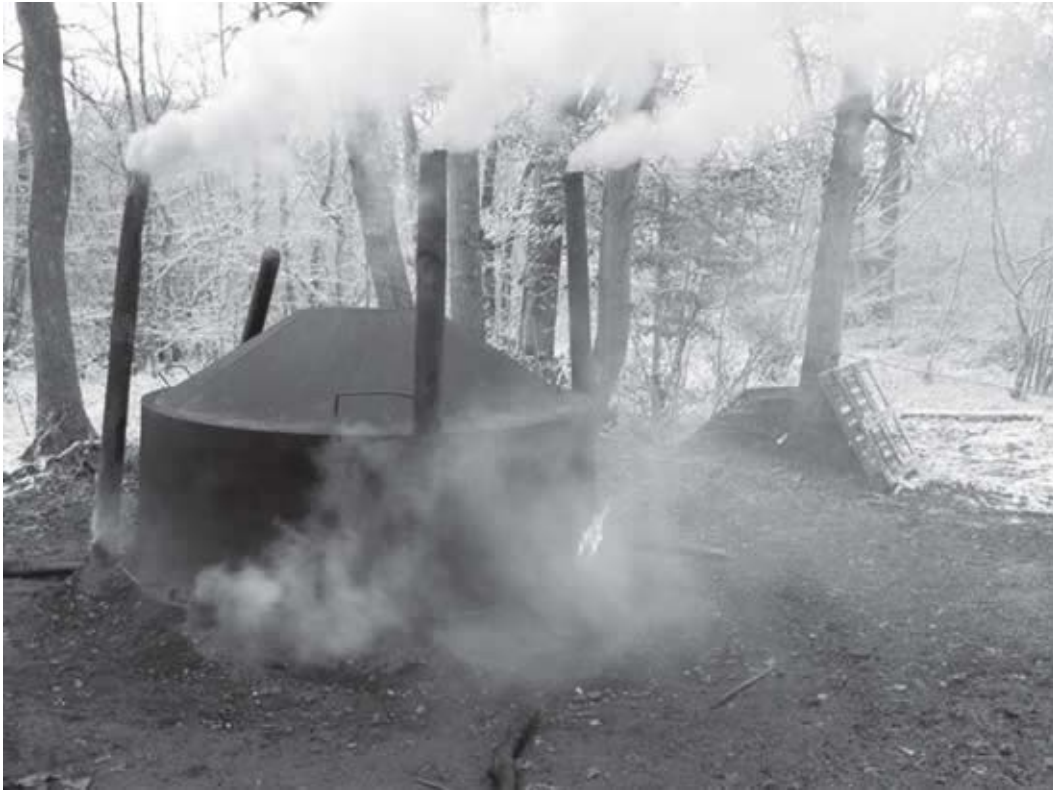
Obtención de carbón de leña. (The Dorset Charcoal Co.)
